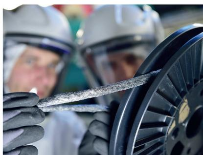
ren, heute zunehmend Entwicklungen zur Reduktion der Mikroplastikimmissionen von Geokunststoffen oder auch das mechanische Recycling von Kohlenstofffasern (Abb.2) ebenso wie der zunehmende Einsatz von Naturfaserstoffen, auch im Leichtbau.
